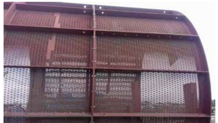
Trómel de gran tamaño para molinos SAG rumbo al cliente en Zambia
