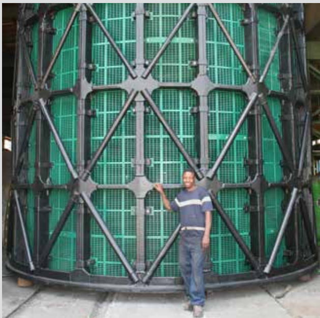
Trómel para molinos SAG de 5 m de diámetro y 5.5 m de largo destinado a una mina en México.
