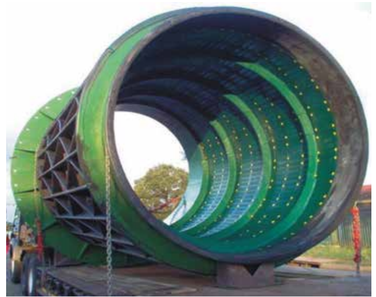
Trómel de gran tamaño para molinos SAG rumbo al cliente en Zambia
